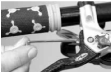
Einstellung des Abstandes der Bremshebel vom Lenker.
