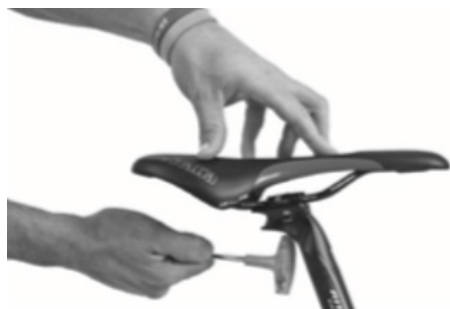
Beide Schrauben mit ca. zwei/drei Umdrehungen lockern.
