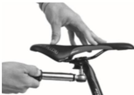
Beide Schrauben langsam und abwechselnd einschrauben und das maximal zulässige Feststellmoment nie überschreiten.
