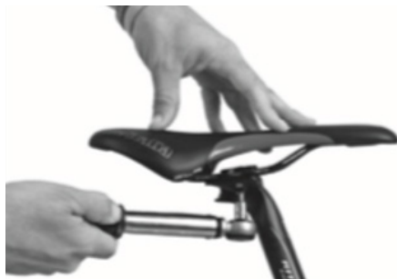
Serrer les deux vis progressivement et alternativement, ne jamais dépasser le couple de serrage maximum autorisé.
