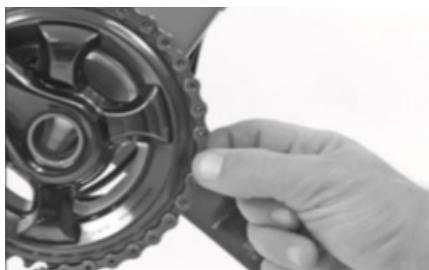
Vérification de l'état de la chaîne.
