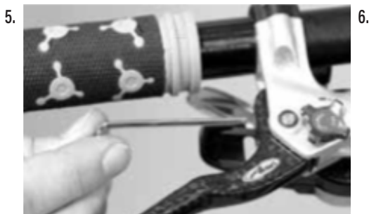
Réglages de la distance du levier de frein au guidon.
